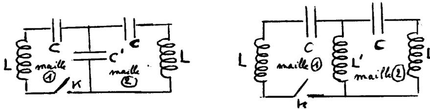
1) Deux circuits  $LC$ , de résistance négligeable, sont couplés par la capacité  $C'$ . On ferme l'interrupteur  $K$  à l'instant  $t = 0$  où seul le condensateur  $C$  (de la maille 1 contenant  $K$ ) porte une charge  $q_{1_0}$ .
