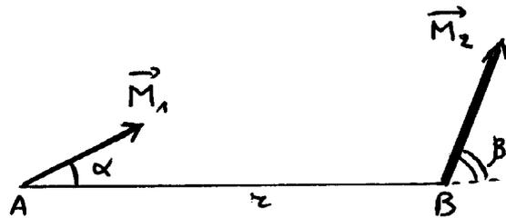
Deux aiguilles aimantées sont assimilées à des dipôles magnétiques de moments  $M_1$  et  $M_2$  de même module  $M$ . Les aiguilles, mobiles sans frottement autour de leurs axes verticaux par rapport auxquels leur moment d'inertie est  $J$ , sont repérées par les angles  $\alpha = (\overline{AB}, \overline{M}_1)$  et  $\beta = (\overline{AB}, \overline{M}_2)$ . On posera  $AB = r$ .
