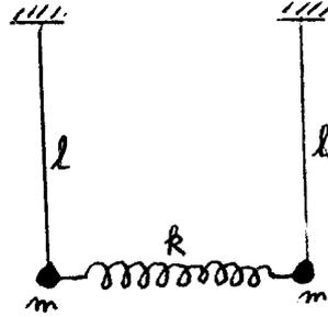
On considère deux pendules simples identiques de masse  $m$ , de longueur  $l$ , reliés par un ressort de raideur  $k$ , de longueur à vide  $L_0$ . Les extrémités fixes  $A$  et  $B$  sont distantes de  $L_0$ . Le ressort reste horizontal. On désignera  $X_1$  et  $X_2$  les déplacements des masses  $m$  des pendules par rapport à l'équilibre.
